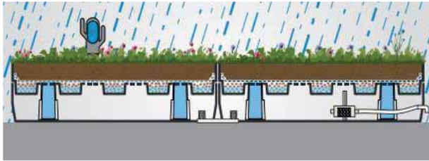
Toiture végétalisée à Mions et schéma de fonctionnement (projet GEPETO, Hydroventiv®) 2
